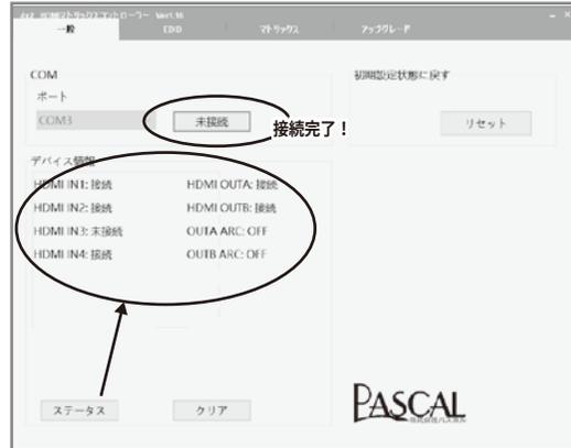
リセット [リセット] をクリックすると本体のリセットボタンと同じ動作をします
